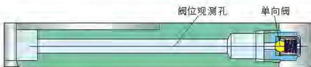
图 9. 阀位可观测及执行器压力保护设计(可选)
